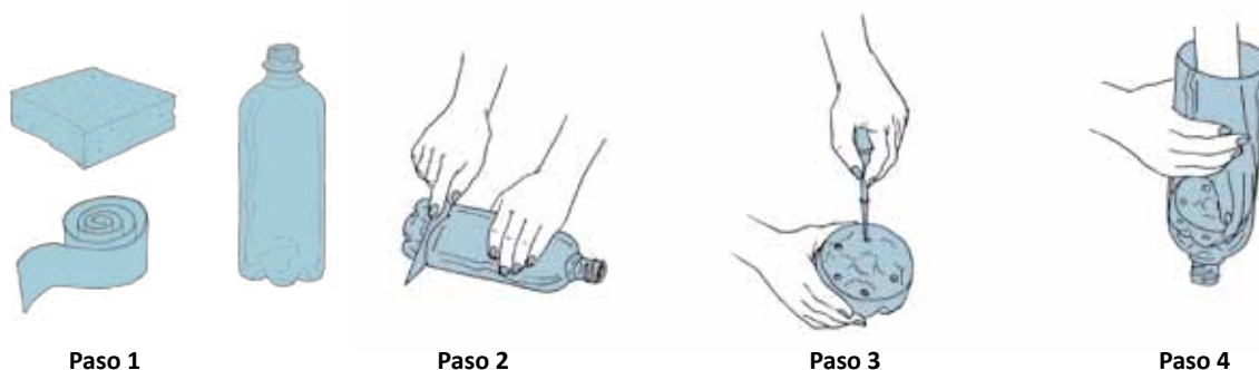
Figura 13: Procedimientos de preparación de un filtro casero
