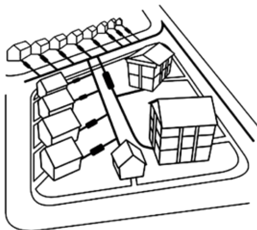
Figura 3: Alcantarillado de pequeño diámetro
