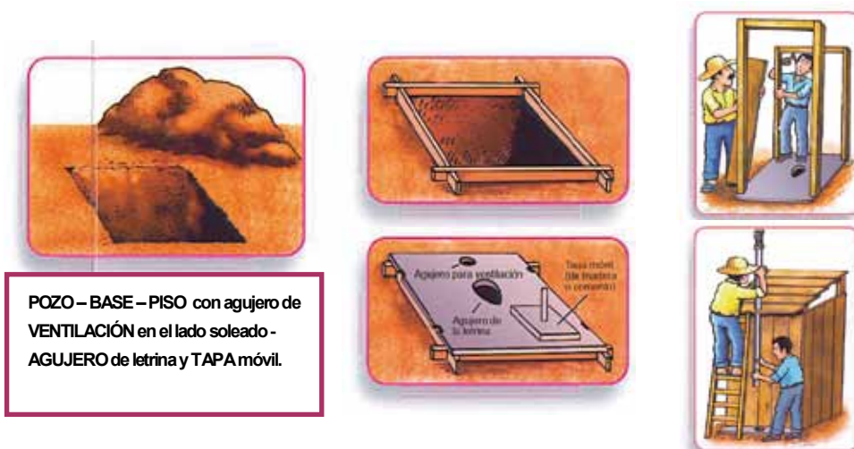
Figura 11: Procedimientos de construcción de la letrina de hoyo seco ventilado
