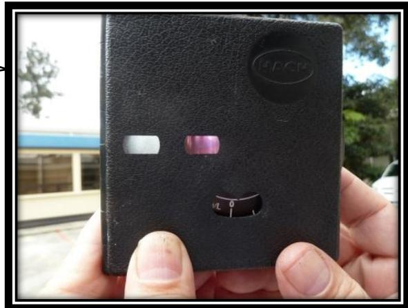
14. La escala inferior indica 0.3 mg/l, como puede observarse el color rosado del disco es mas débil, comparado con la muestra, significa que el agua tiene mas cloro, por lo que hay que girar mas el disco
