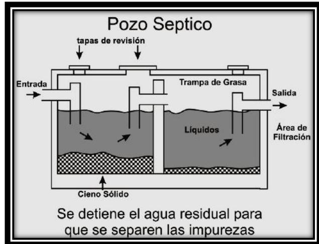
En las fosas sépticas se deposita la materia sólida por decantación, al permanecer el agua residual en el tanque, lo que permite que se decanten o depositen los sedimentos en donde se degradan, y flote la capa de impurezas. Para que esta separación ocurra, el agua residual debe permanecer en el tanque un mínimo de 24 horas.
