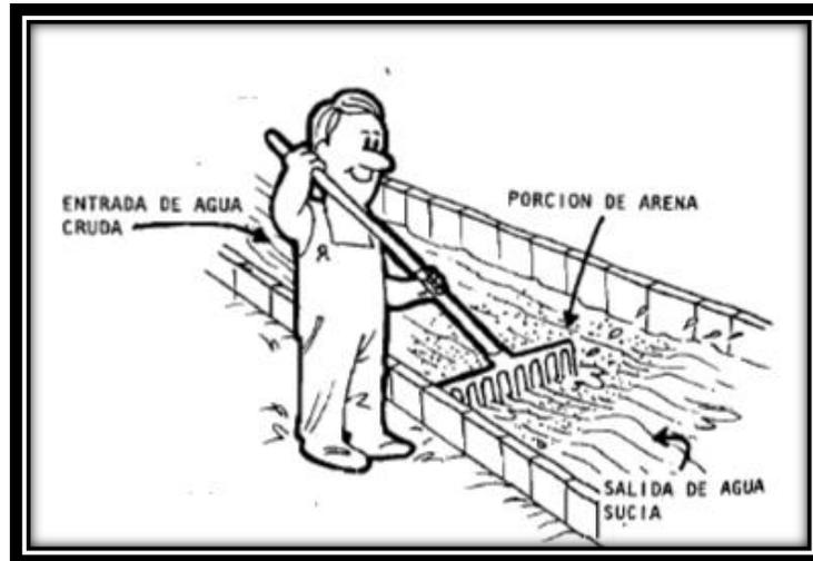
Figura XX. Sistema de lavado de arena en canal
