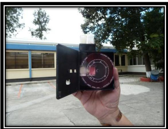
13. Comparamos visualmente la muestra con los valores del disco. Giramos el disco hasta encontrar el color que sea igual al color de la muestra. El color claro en el disco indica que no hay cloro en el agua.
