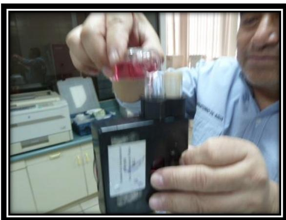
10. Llenar el tubo interior del comparador con la muestra del frasquito, para compararla con los valores indicados en el disco interno del comparador.
