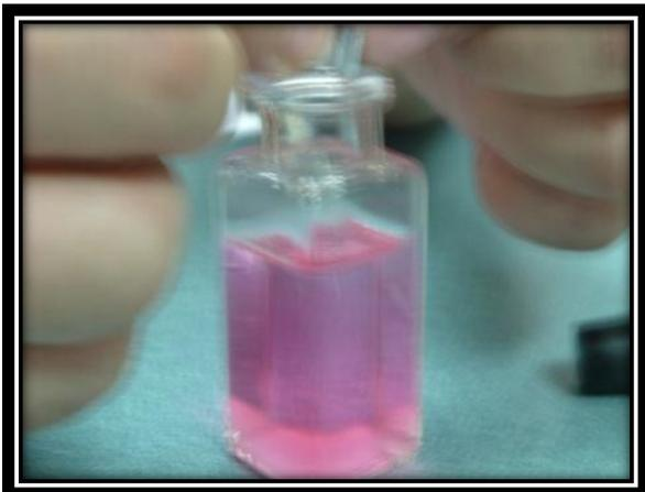
8. El reactivo reacciona si el agua tiene cloro y cambiará de un color rosado suave a un rosado fuerte, como se muestra en la fotografía. Si no cambia de color, el agua no tiene cloro
